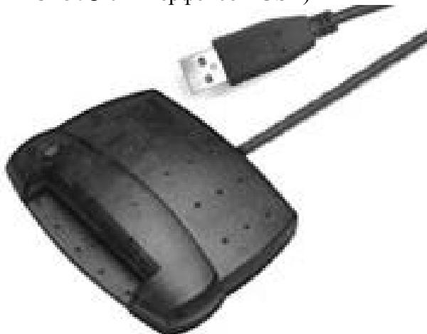
**Устройства чтения/записи смарткарт** – в последнее время получают распространение чиповые карты и устройства чтения/записи таких карт (ридеры). Многие производители выпускают версии своих устройств предназначенные для использования последовательного порта RS232 а так же USB1.0. Примерами таких ридеров могут служить ACR30U производства (Advanced Card Systems), GCR410(производства Gemplus), ряд устройств производства Schumberger, ридеры Towitoko (распространяемые в России под маркой РусКард).
