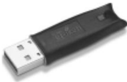
Существуют так же смарткарты, которые могут при помощи примитивного переходника подключаться непосредственно к шине USB, в частности чиповая карта eGate производства Schlumberger. В этом случае считыватель представляет из себя просто держатель и колодку с разводкой проводов от контактов смарткарты к контактам стандартного разъема USB типа “вилка”.
